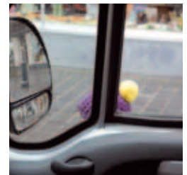
Eingeschränkte Sicht in den direkt einsehbaren Bereich durch erhöhte Sitzposition des Lkw-Fahrers
