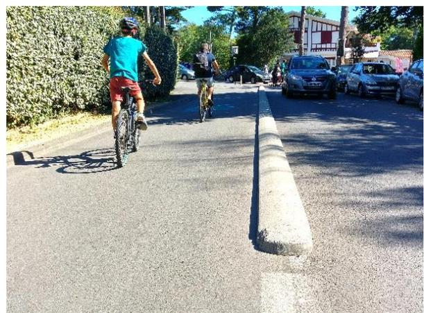
Abbildung 4: bauliche Trennung Radweg zur Fahrbahn
