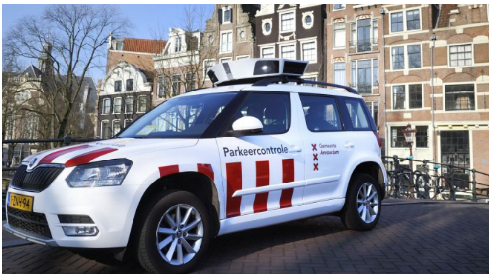
Abbildung 18 Digitale Parkraumüberwachung in Amsterdam mittels SCANaCAR-System Quelle: BT
