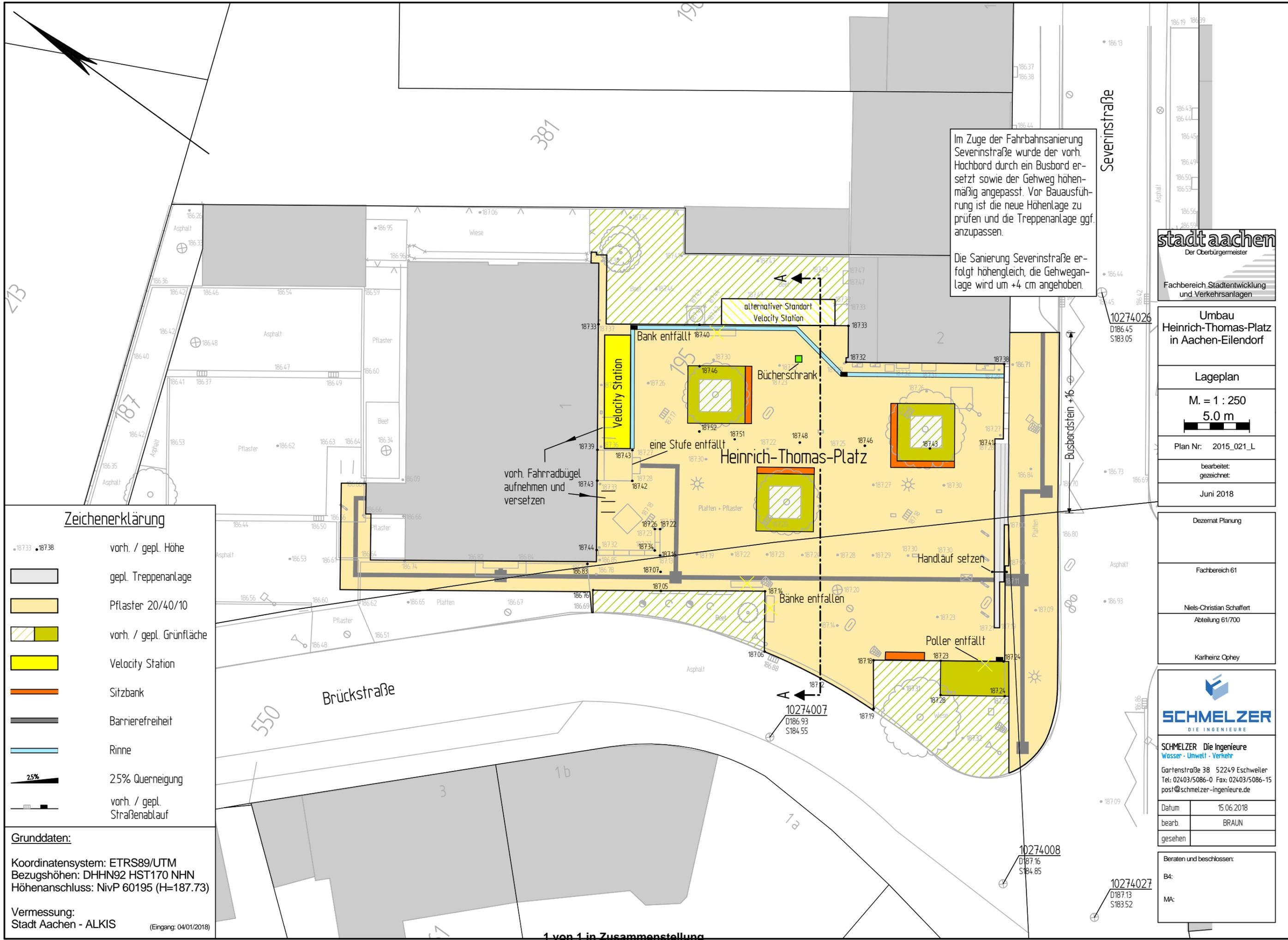
Im Zuge der Fahrbahnsanierung Severinstraße wurde der voh. Hochbord durch ein Busbord ersetzt sowie der Gehweg höhenmäßig angepasst. Vor Bauausführung ist die neue Höhenlage zu prüfen und die Treppenanlage ggf. anzupassen.
