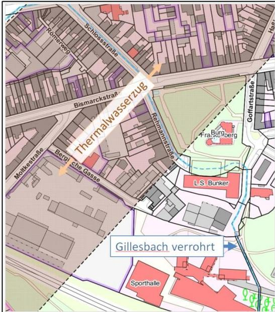
Abb. 4 Verlauf verrohrtes Gewässer / Thermalwasserzug
