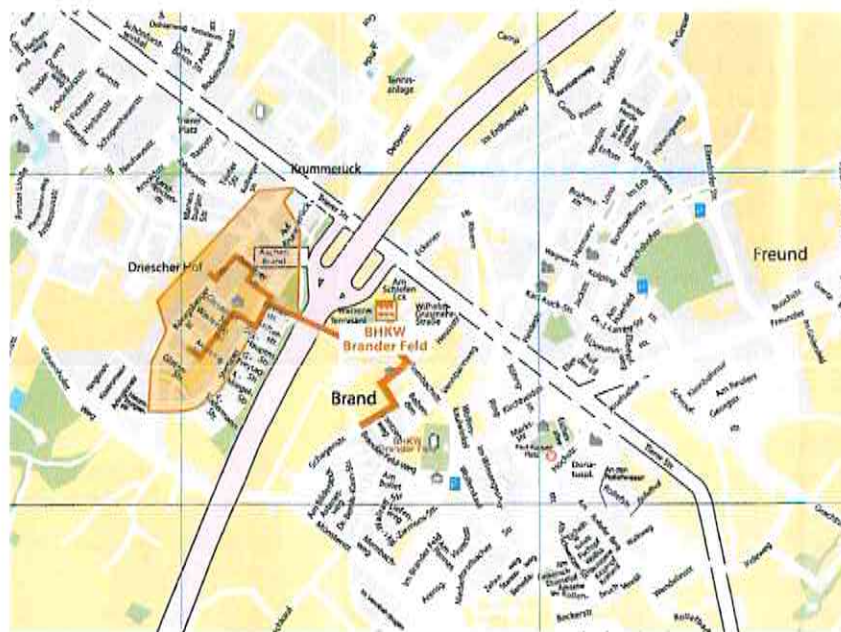
Abbildung 30: Fernwärmenetz im Stadtteil Aachen-Brand
