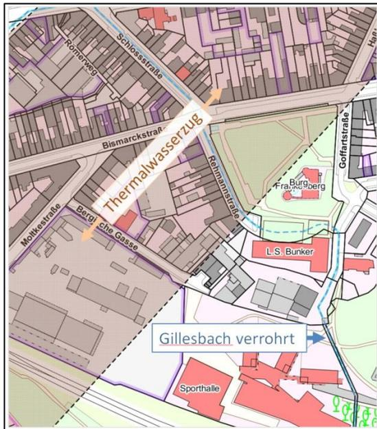
Abb. 4 Verlauf verrohrtes Gewässer / Thermalwasserzug
