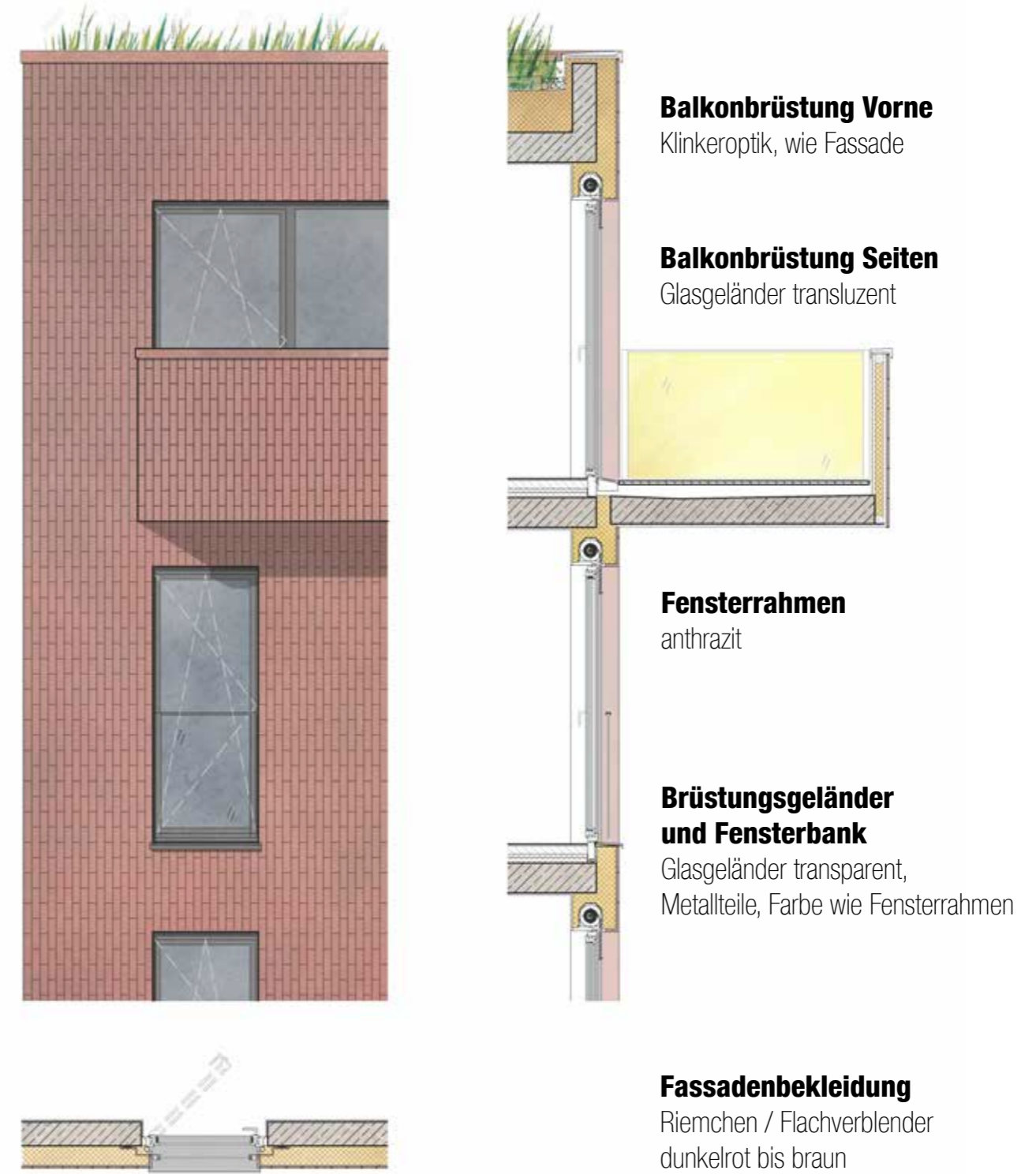
Vorentwurf Fassadendetail Franzstraße aus der Leistungsphase II
