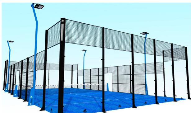
Die Flutlichtanlage pro Platz besteht aus 8 LED Strahlern a 200W auf 4 Masten.
