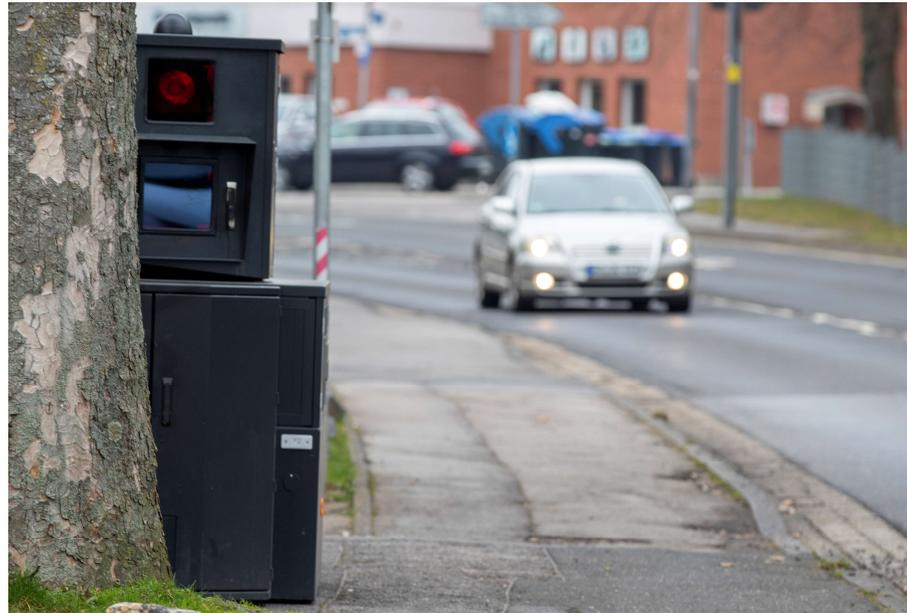
Bei einer zulässigen Höchstgeschwindigkeit zwischen 60 km/h und 70 km/h hat eine Sicherung von semistationären oder stationären Geschwindigkeitsüberwachungsanlagen durch ein Fahrzeugrückhaltesystem zu erfolgen, sofern diese weniger als 4,5 Meter von Fahrbahnrand entfernt eingerichtet sind.
