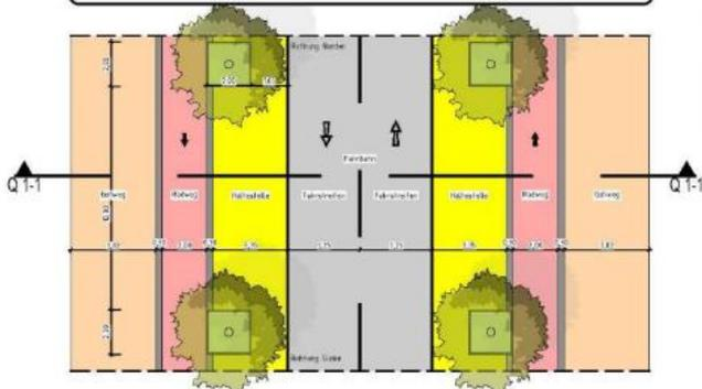
Nur kurze bauliche Führung des Radverkehrs im Seitenraum möglich
