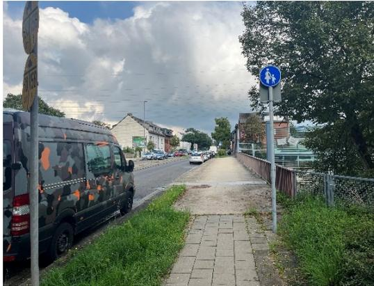
Abbildung 43: Ende der Freigabe des Gehwegs für den Radverkehr / fehlende Überleitung auf die Fahrbahn
