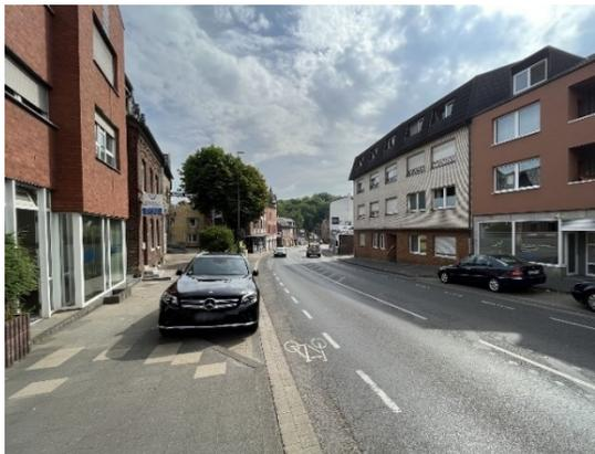
Abbildung 45: Fehlende Sicherheitstrennstreifen zwischen dem Schutzstreifen und dem ruhenden Verkehr an der Von-Coels-Straße
