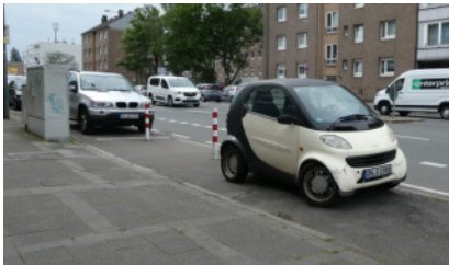
Abb. 53: Vorgezogener Seitenraum zur Querung (Höhe Trierer Str. 107)
