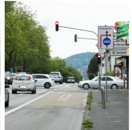
Abb. 20: Fehlende Hochbordse und nicht ausreichend dimensionierte Wartebereiche Haltestelle Tierpark
