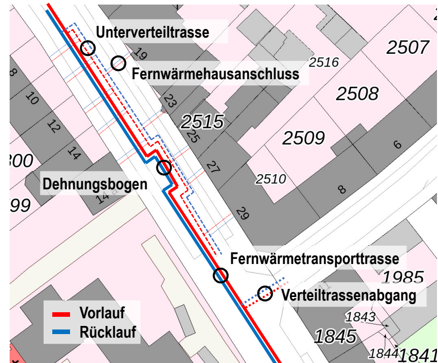
Leitungstrassen alleine im Fernwärmeleitungsbau
