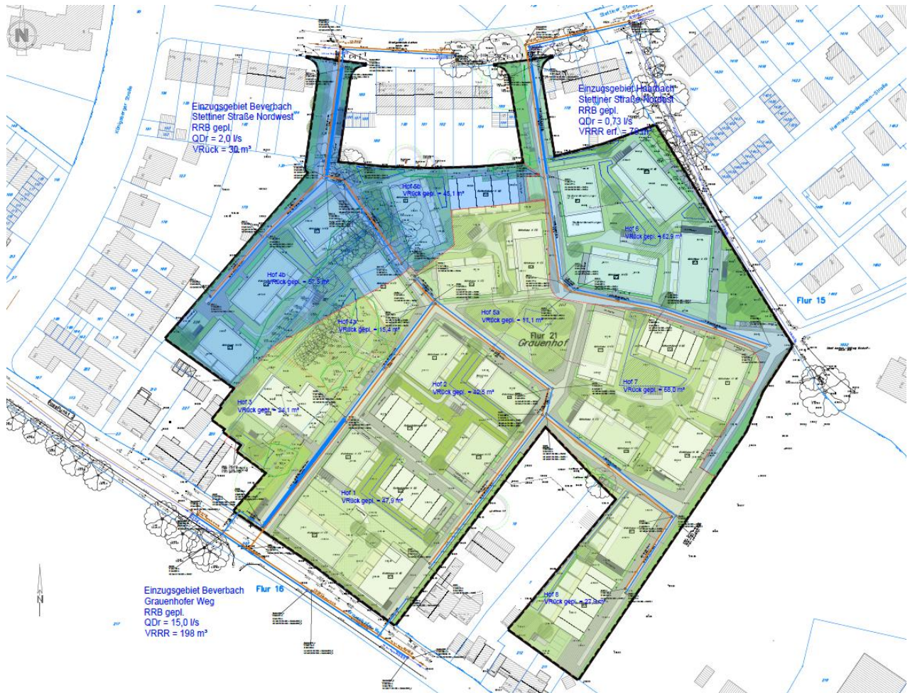
Abb. 8: Lageplan Geländemulden, unterirdische Regenrückhaltekanäle bzw. Rückhaltebauwerke (RRB)
