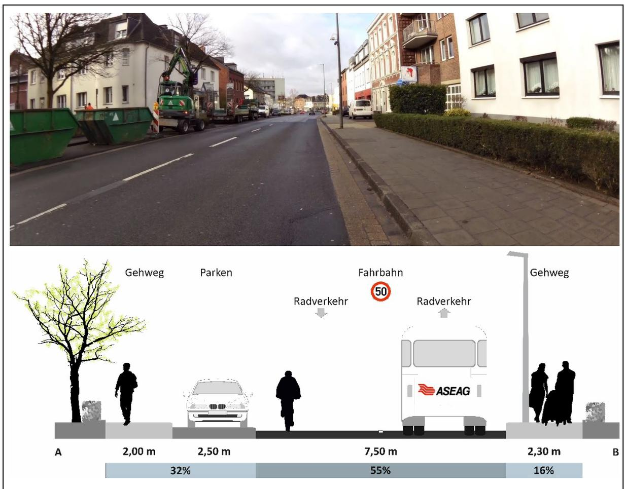
Bild 4-6: Querschnitt Q1 im Bereich Josefsallee (Höhe Haus-Nr. 30) – heutiger Verkehrsraum 14,30m
