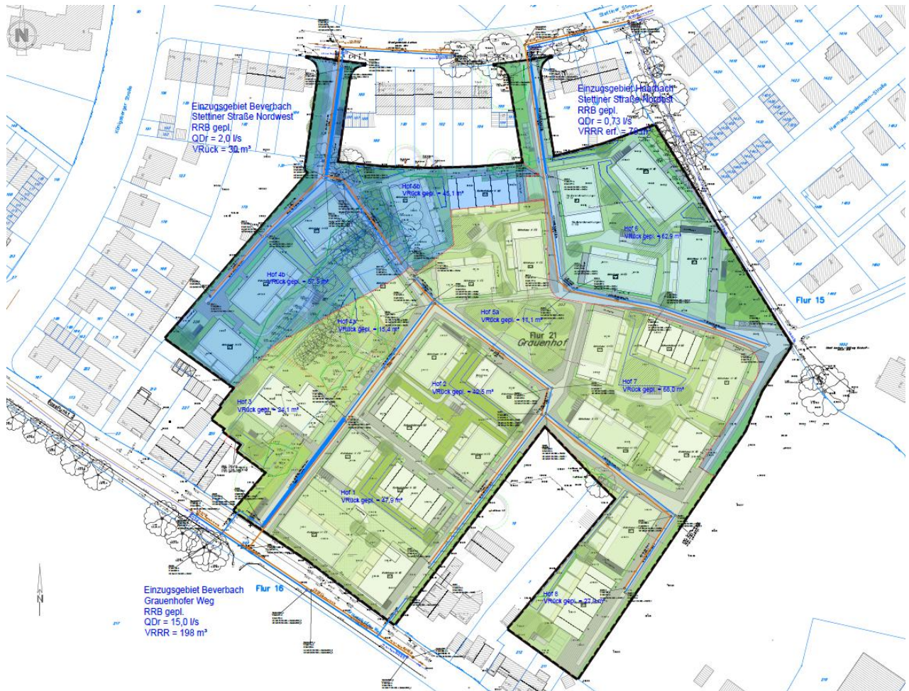
Abb. 8: Lageplan Geländemulden, unterirdische Regenrückhaltekanäle bzw. Rückhaltebauwerke (RRB)
