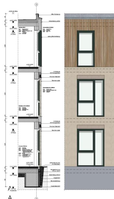
Abb. 24 Fassadenschnitt Kita\_HWR
