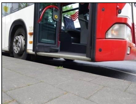
Abb. 3-6: Absenkung mittels Kneelingtechnik Quelle: ASEAG
