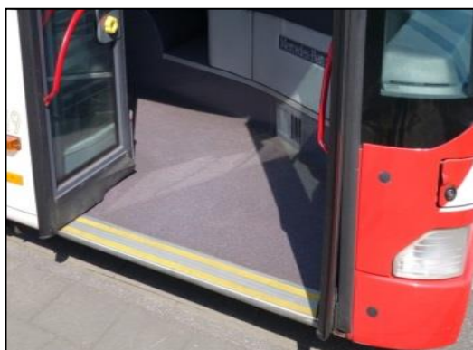
Abb. 3-4: Einstieg vordere Türe Niederflurfahrzeuge Quelle: ASEAG
