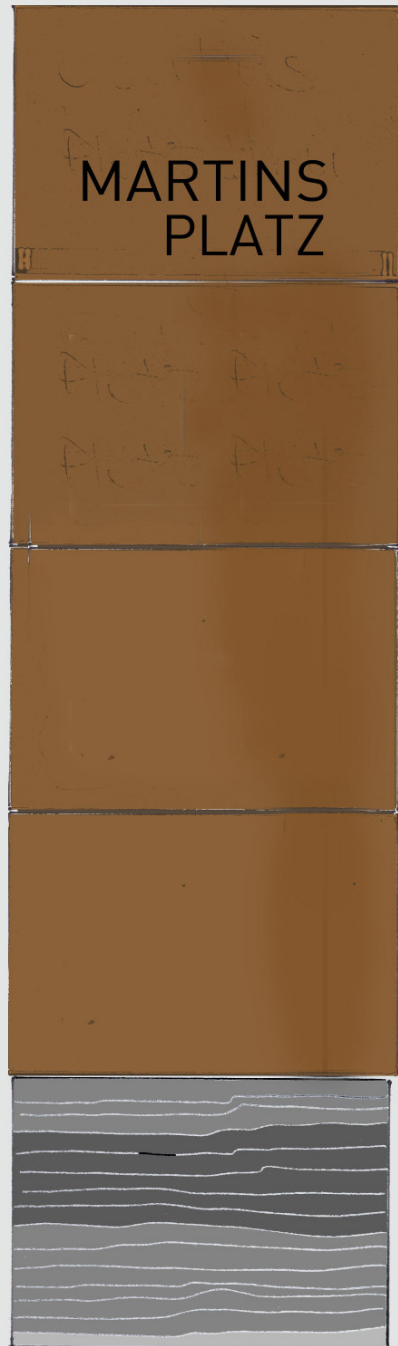
Vorderseite aus Cortenstahltafeln
