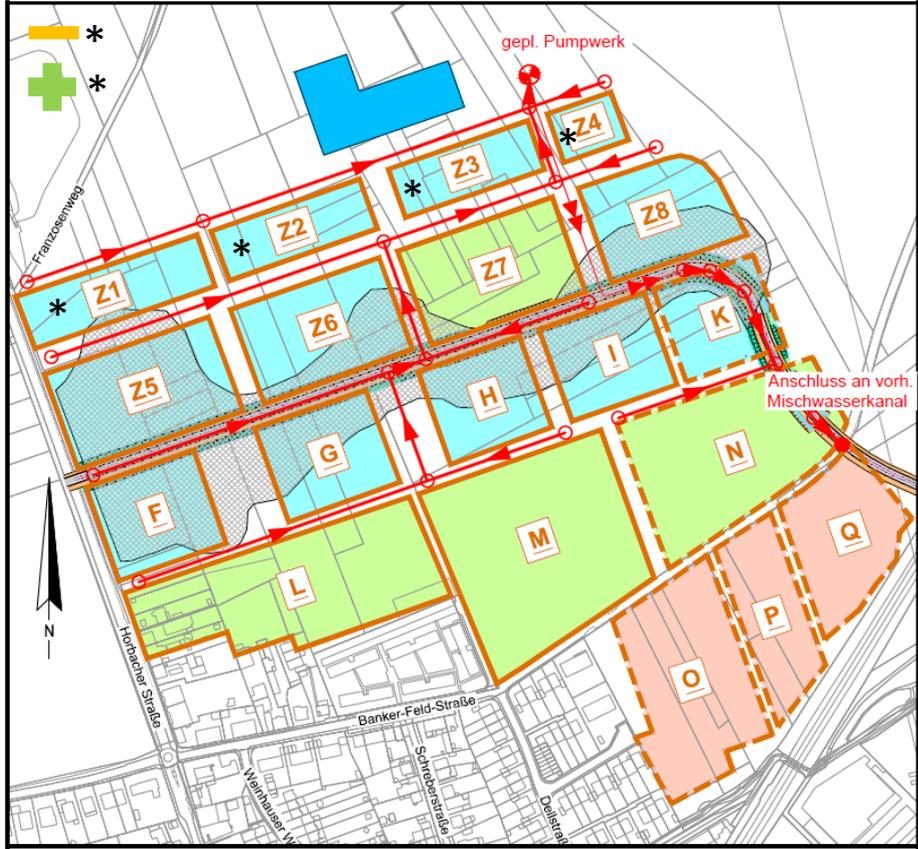
Variante 2 - HAUPTSCHLIEßUNG in Mittellage, geländenah
