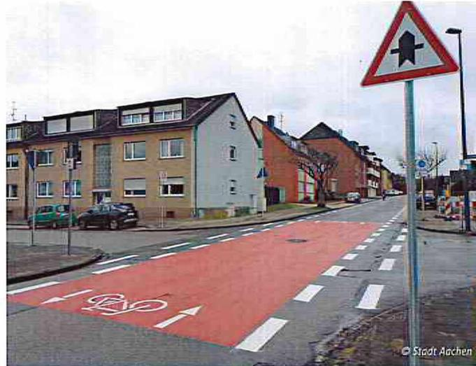
Rot eingefärbte Kreuzungen unterstützen die Vorfahrtberechtigung der Fahrradstraße. Seit 2021 werden Fahrradstraßen vollflächig rot eingefärbt. Um die geltende Vorfahrtregelung zu verdeutlichen und Fuß- und Radverkehr zu schützen, können an Einmündungen Gehwege niveaugeleichen fortgeführt werden. Für den ein- und abbiegenden Kfz-Verkehr entsteht hierdurch eine Anrampung.
