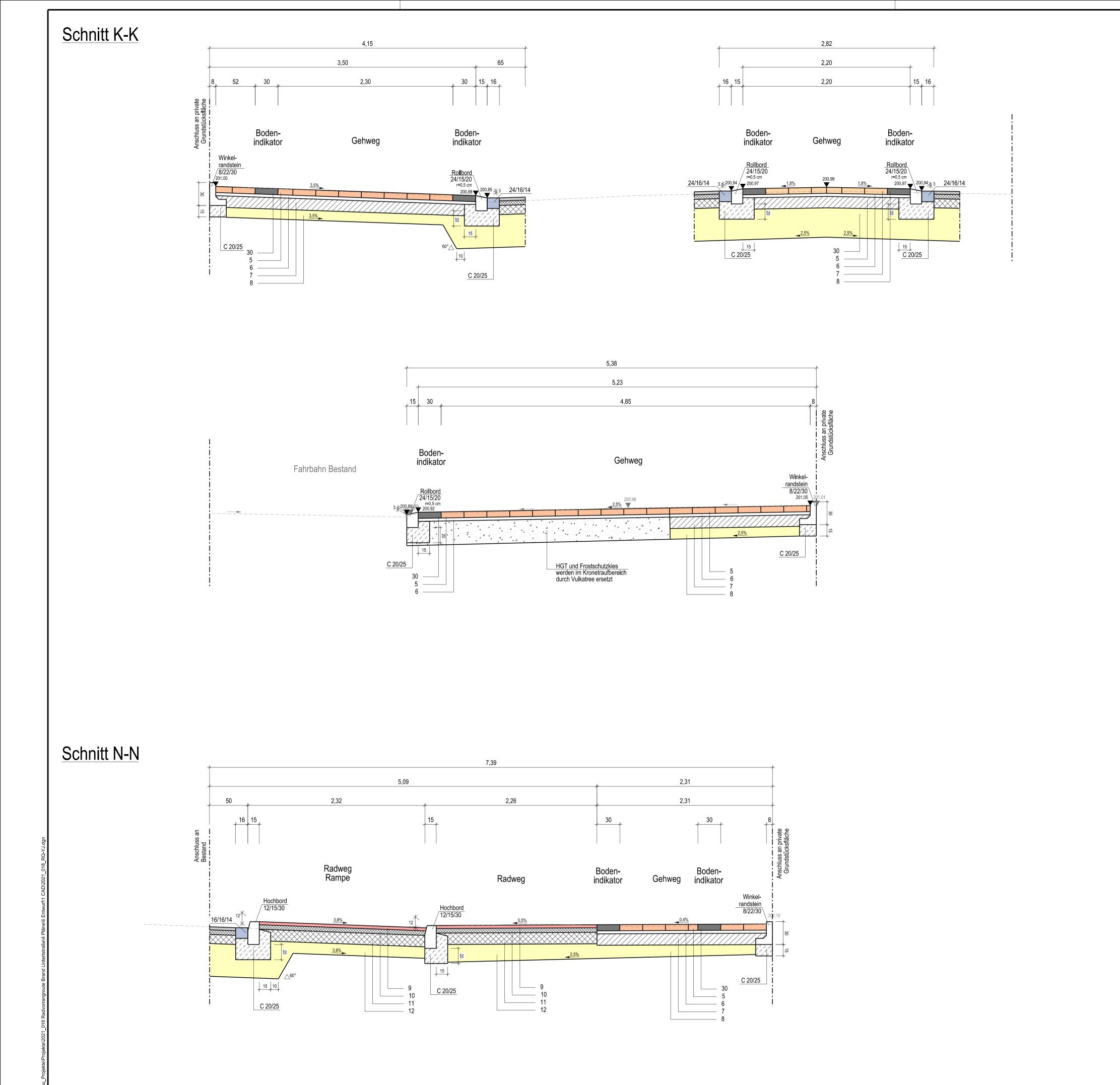
RStO 12, Tafel 6, Zeile 1 5 8 cm Betonplatten 30/30, grau (mit Fugenverbundsystem) 6 3-5 cm Brechsand-Splittgemisch 0/5
