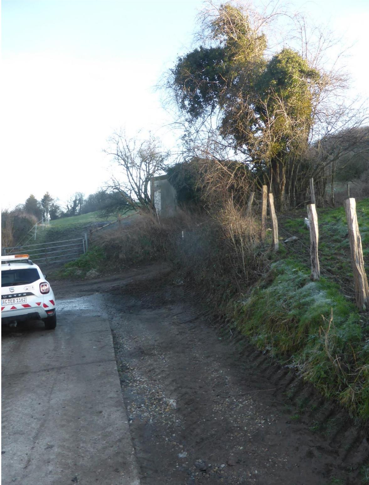
Foto 3: Ansicht des anzupassenden Wegebereichs für die Erhöhung des Kurvenradius; rechts die Gehölzgruppe, die für die Anpassung der Böschungen entfallen würde
