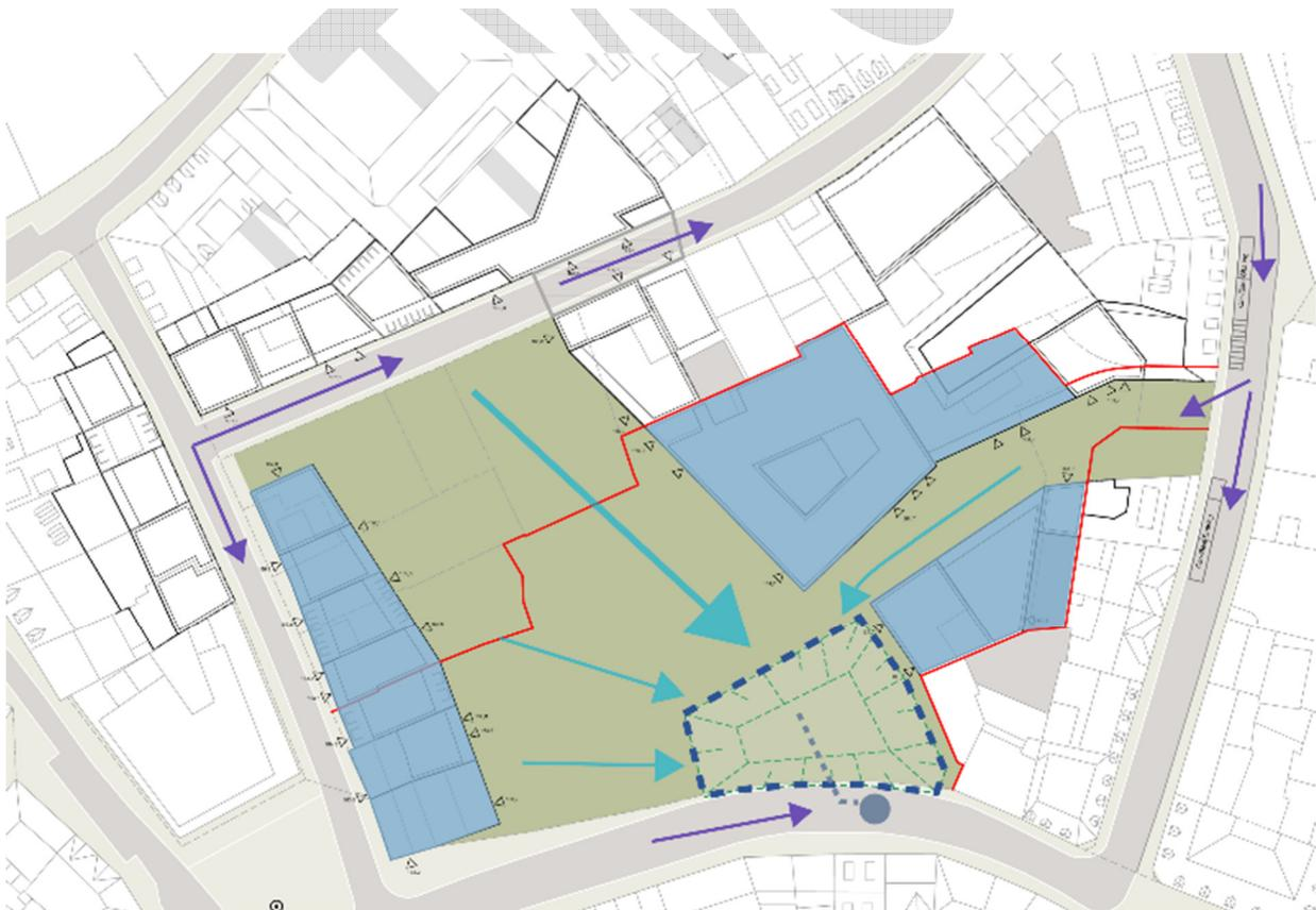
32 Prinzipskizze Starkregenrückhaltung (Volumen rd. 315 m<sup>3</sup>)
