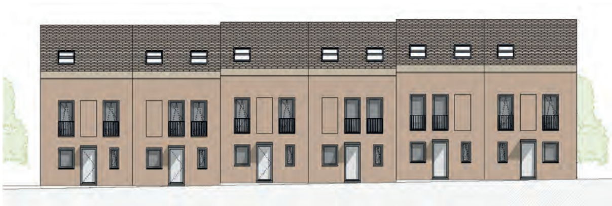
Abbildung 02: Beispielhafter Höhenversatz (Reihenhaus kompakt-gefördert)
