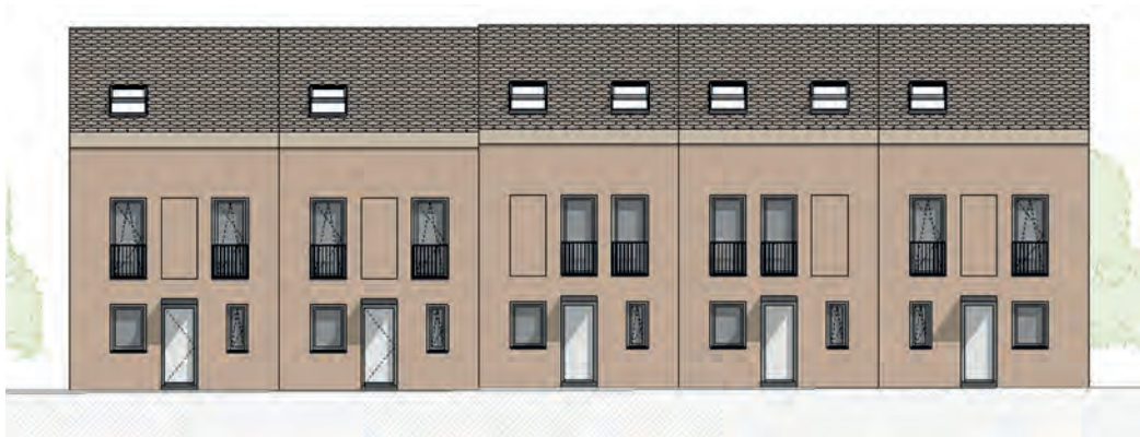
Abbildung 01: Beispielhafter Höhenversatz (Reihenhaus Standard-Satteldach)
