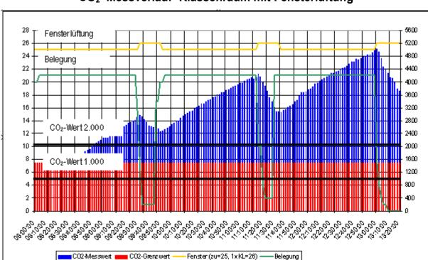
CO<sub>2</sub> Messverlauf- Klassenraum mit Fensterlüftung
